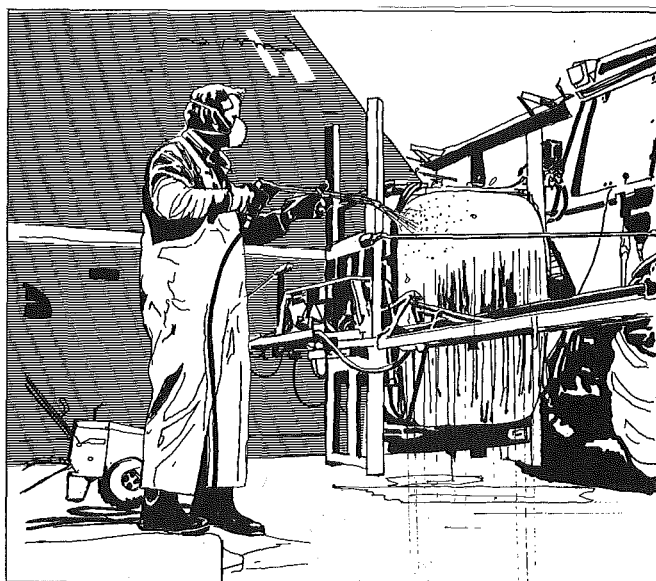
Figura 22. Limpieza a fondo de todo el equipo utilizado para la aplicación de productos agroquímicos. Póngase cuidado en no contaminar el medio ambiente con aguas residuales
